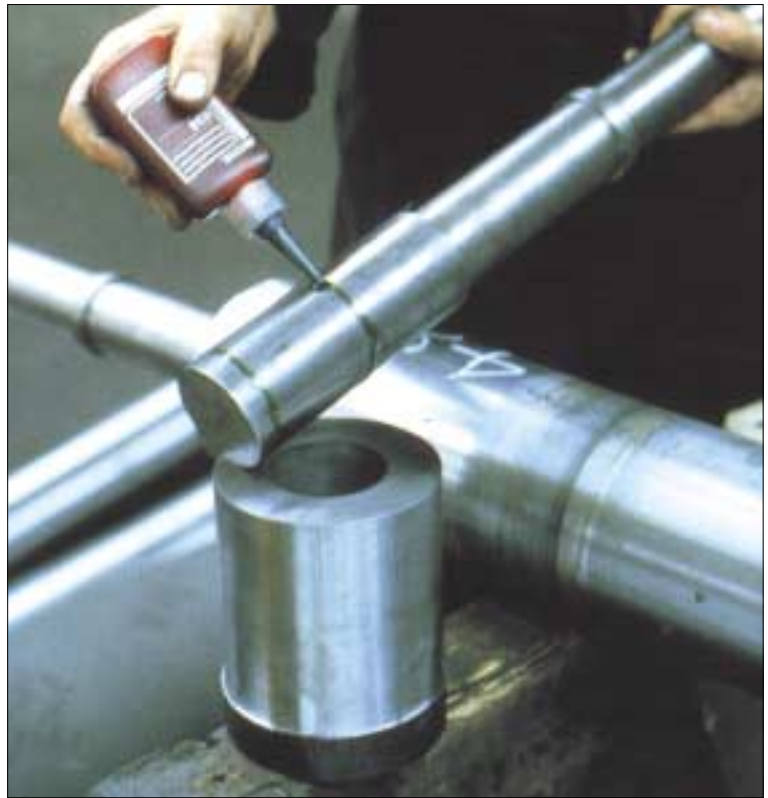
Fixarea cu adeziv a arborelui în bucușa de susținere a tamburului a economisit 1,5 ore de uzinare pe strung.
