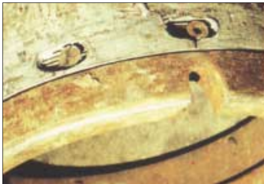
Vibrația piesei interioare determină alungirea găurilor pentru șuruburile de fixare și apariția jocului între tambur și piesa interioară.
