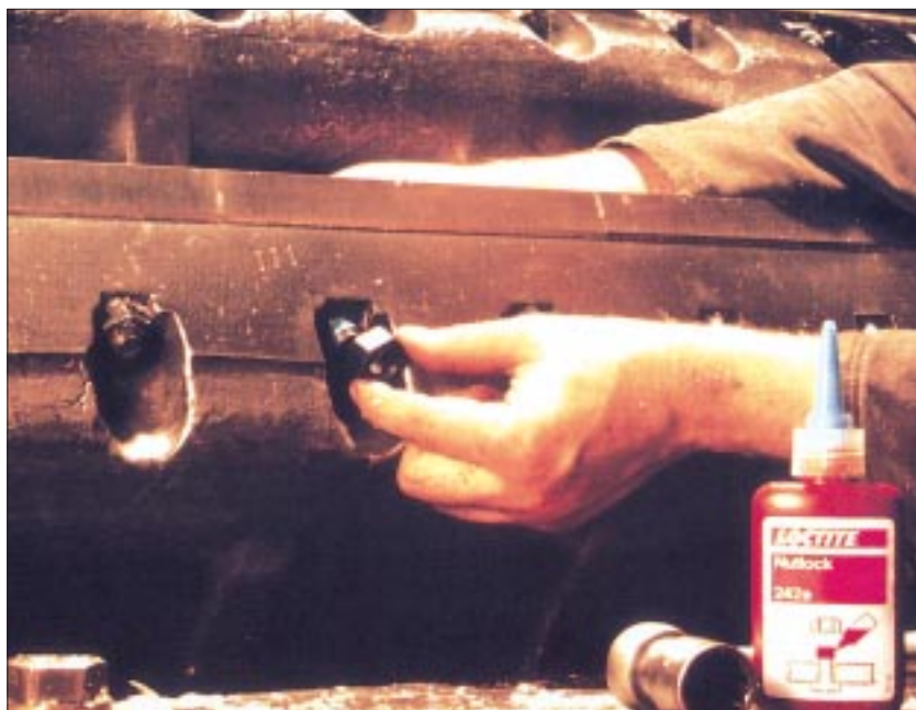
Șuruburile pentru cuțitul dispozitivului de tăiat folii de masă plastică au fost asigurate cu piulițe cu autoasigurare, care s-au desfăcut în urma vibrațiilor. Acum ele sunt asigurate cu Loctite 243.
