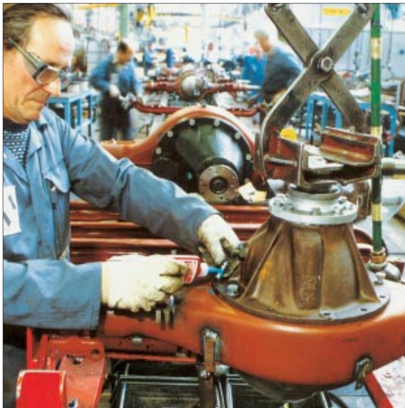
Șuruburile care trec prin găurile diferențialului în carcasa axului sunt în același timp asigurate și etanșate.
